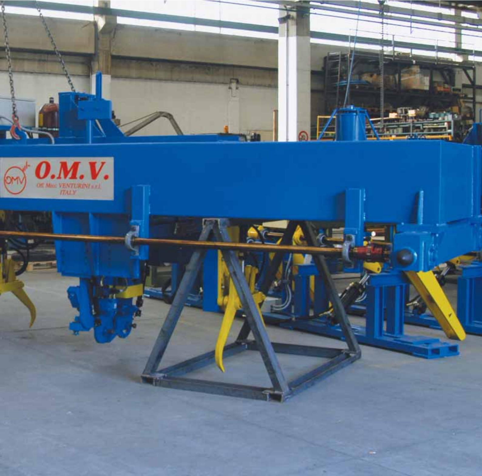
E' disponibile inoltre un carrello che permette di muovere lateralmente la legatrice, per consentire di variare gli interassi di legatura, qualora vi siano più macchine sulla stessa linea, adattandola a diversi tipi di produzione, mantenendo sempre la conformazione ottimale.
