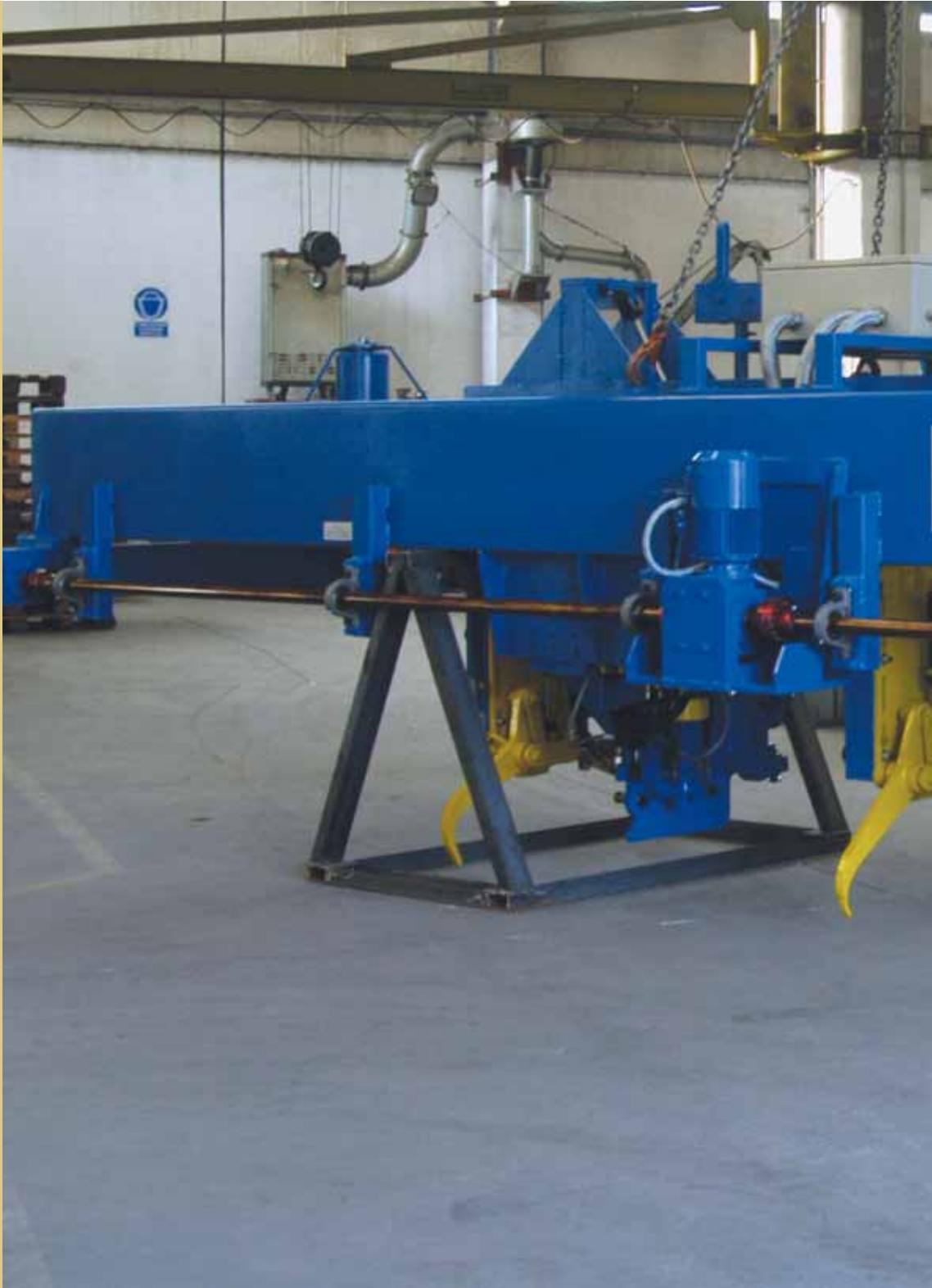
La piegatrice (PGT) e la legatrice (LFP), sono due macchine che possono essere combinate fra loro per piegare i fasci di barre tonde (tramite PGT) che poi passeranno alla legatura per mezzo della LFP (peso max del fascio 400 kg).
