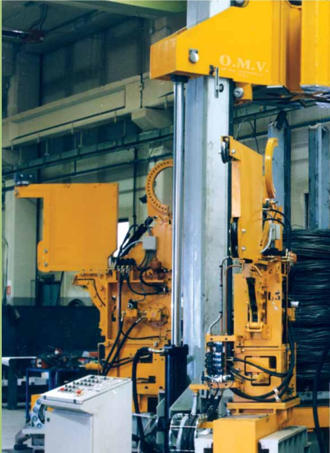
Questa macchina è adatta al confezionamento di matasse di medie e grandi dimensioni (con altezze fino a 3 - 3,5 mt) che vengono prima pressate per minimizzarne l'ingombro e successivamente legate attraverso un nodo ad alta resistenza posizionato parallelamente all'asse della matassa e di forma piatta. Le matasse in questo caso devono essere trasportate verticalmente con un sistema a pallet, trascinati da rulli motorizzati.
