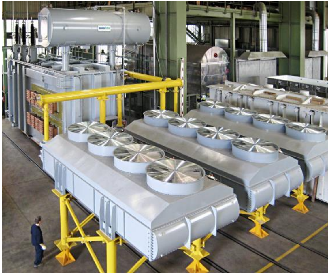
FATA - Rectifier Transformer - 124 MVA, 132000/1140 V
